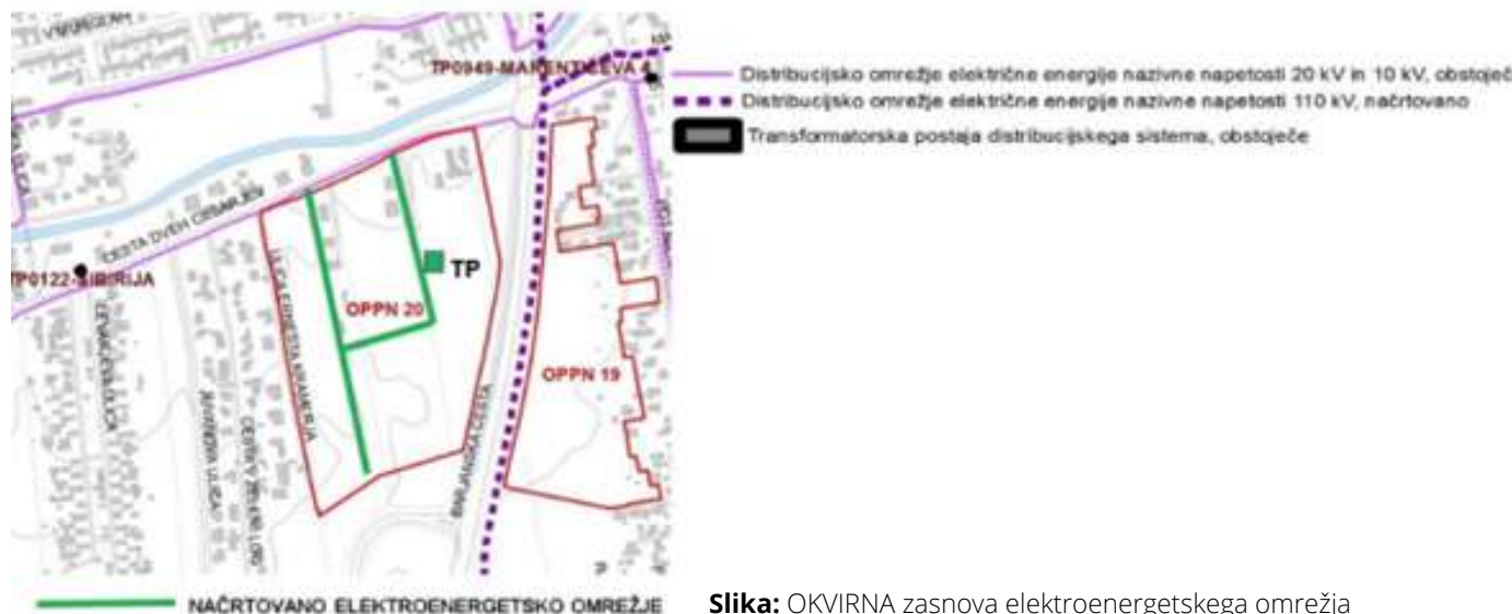
Slika: OKVIRNA zasnova elektroenergetskega omrežja
