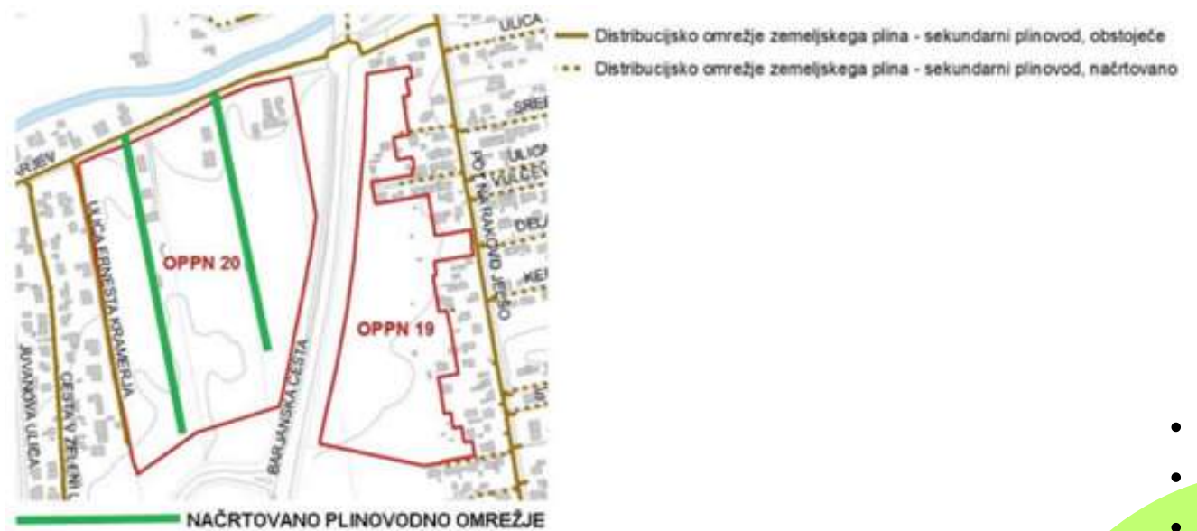
Slika: OKVIRNA zasnova plinovodnega omrežja
