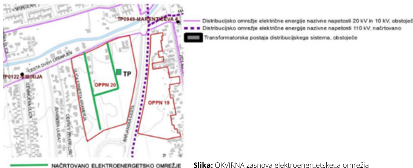
Slika: OKVIRNA zasnova elektroenergetskega omrežja
